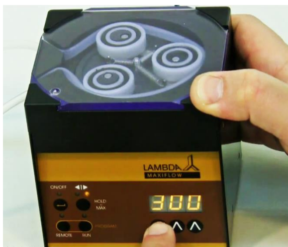
Obrázek 1-11 Tlačítka Λ Λ Λ lze použít pro nastavení požadovaného průtoku.
