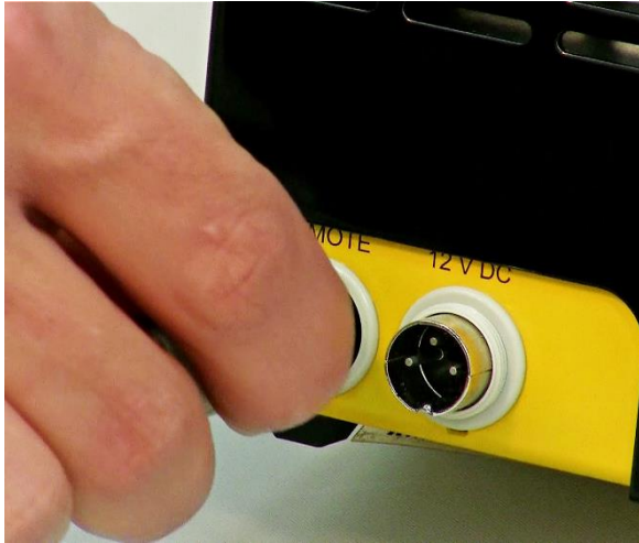
Obrázek 3-1 Pro dálkové ovládání pumpy zapojte 8-pólový kabel dálkového ovládání do konektoru "Remote" na zadní straně peristaltické pumpy.
