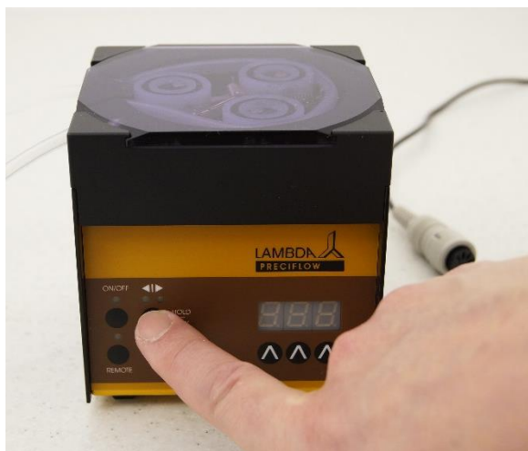
Obrázek 3-3 Odpojte pumpu z elektrické sítě. Při stálém stisknutí směrového tlačítka ◀▶ připojte pumpu znovu k síti.
