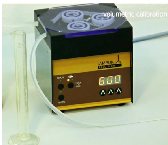
Obrázek 2-1 Spojte hadičku se zdrojem kapaliny a nastavte požadovanou rychlost (například 600). Připravte si odměrný válec.
