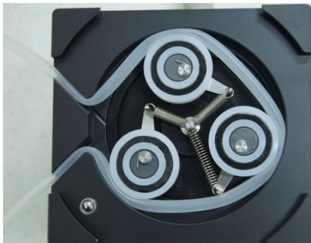
Obrázek 6-1 Velký průměr hlavy peristaltické pumpy s kuličkovými ložisky a asymetrickým vzhledem pro snížení pulzace a zvýšení životnosti hadiček.
