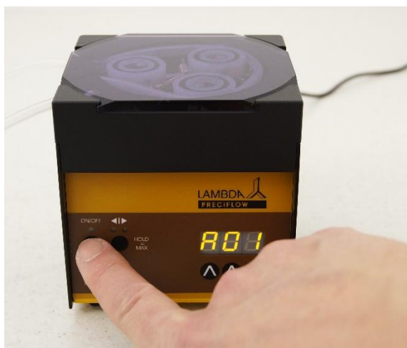
Obrázek 3-6 Pro uložení nové požadované adresy stiskněte tlačítko ON/OFF.
