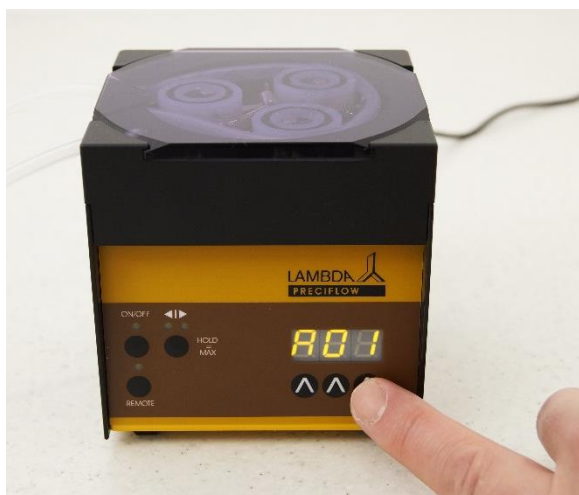
Obrázek 3-5 Pokud chcete změnit adresu pumpy, stiskněte tlačítka ^ ^ ^ pod displejem a nastavte nové požadované číslo adresy.
