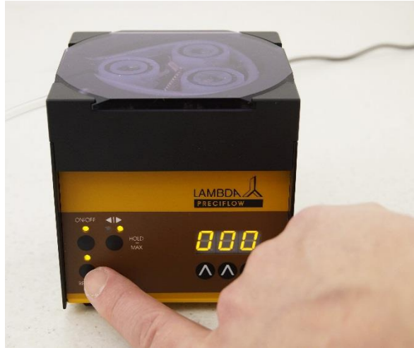
Obrázek 3-2 Stiskněte tlačítko REMOTE na předním panelu pumpy. Odpovídající LED dioda se rozsvítí a na displeji se ukáže přibližné napětí externího signálu.
