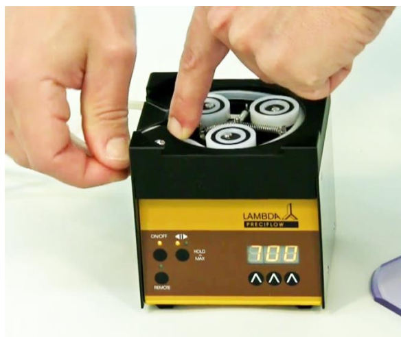
Obrázek 1-8 Vtlačíme hadičku do přední drážky dle obrázku.
