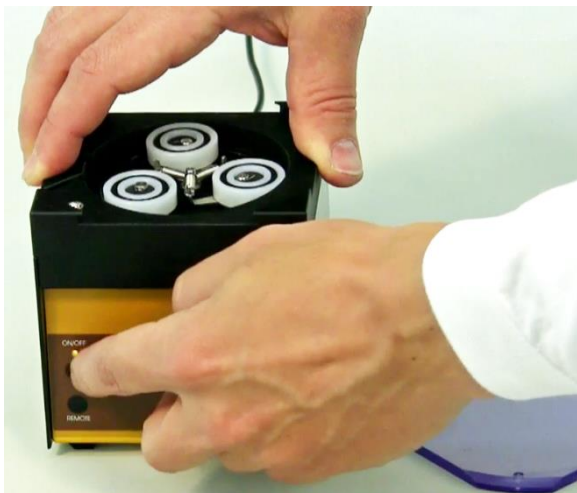
Obrázek 1-5 Stiskněte tlačítko ON / OFF a vyberte směr otáčení peristaltické pumpy stisknutím tlačítka ◀▶.
