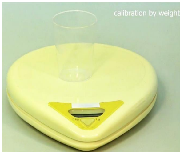
Obrázek 2-5 Zvažte hmotnost prázdné kádinky. Pro přesné zjištění hmotnosti přečerpané kapaliny vytárujte (vynulujte) váhy s kádinkou (např. 0,000 g).
