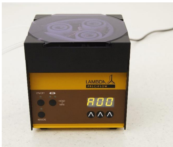
Obrázek 3-4 Na displeji se objeví zpráva "A" a následně dvě čísla od 00 do 99, která indikují aktuální adresu pumpy.
