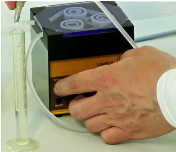
Obrázek 2-3 Přesně po 60 sekundách vypněte pumpu.
